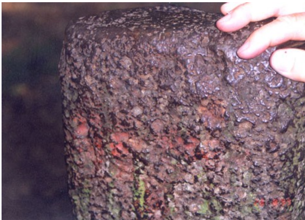
Detail povrchu železného zkorodovaného mezníku (Der Eiserne Mann) v Kottenforstu u Bonnu
