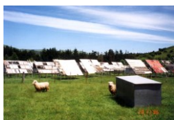
Zkušební stanice atmosférické koroze
