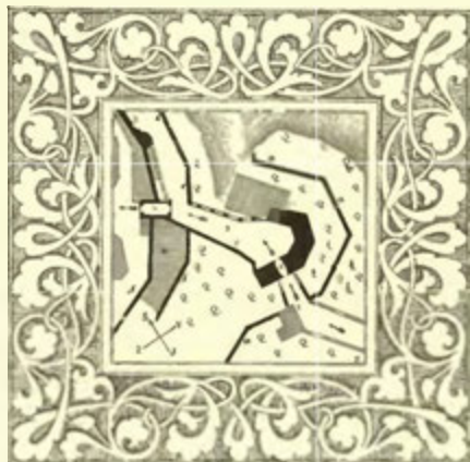
Plán bývalé Pražské brány a opevnění na těch stranách v Táboře (kreslil prof. Janoušek): 1. první vrata; 2. prostřední vrata neb brána vyobrazená na str. 159.; 3. parkán; 4. brána zadní, vyobrazení na str. 160.; a) venkovská hradba, b) prostřední hradba, c) vnitřní hradba, d) divadlo.
