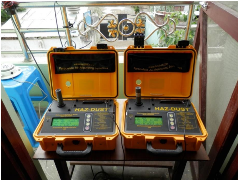
Obr. 3.3 Monitory Haz-Dust EPAM-5000 na měření koncentrace částic PM_{10} , PM_{2,5} a PM_1 .
