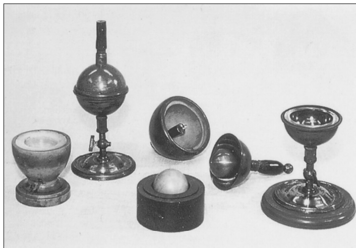
Obr. 26.11 Jednoduché elektrostatické přístroje používané Faradayem. Složený přístroj (druhý zleva) se skládá z vnitřní mosazné koule a z vnější soustředné mosazné kulové vrstvy. Do prostoru mezi kouli a kulovou vrstvou vložil Faraday vrstvu dielektrika.
