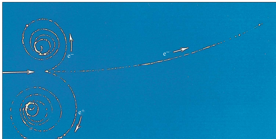
Obr. 29.3 Trajektorie dvou elektronů e^- a pozitronu e^+ v bublinkové komoře umístěné v homogenním magnetickém poli (směr pole je kolmý k rovině obrázku směrem k pozorovateli).
