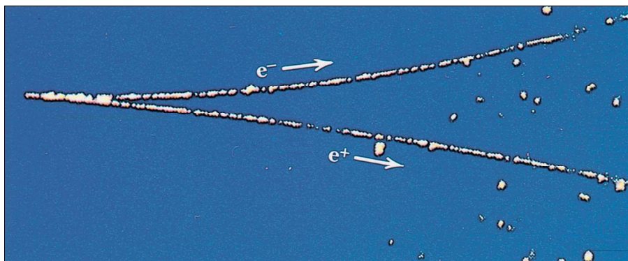
Obr. 22.10 Fotografie stop, které zanechaly v bublinkové komoře elektron e^- a pozitron e^+ . Dvojice částic vznikla z \gamma -záření, které vniklo do komory zleva. Protože \gamma -záření nemá náboj, nezanechává žádnou stopu podél své dráhy (na rozdíl od elektronu a pozitronu). Stopy jsou tvořeny nepatrnými bublinkami vzniklými v přehřáté kapalině.
