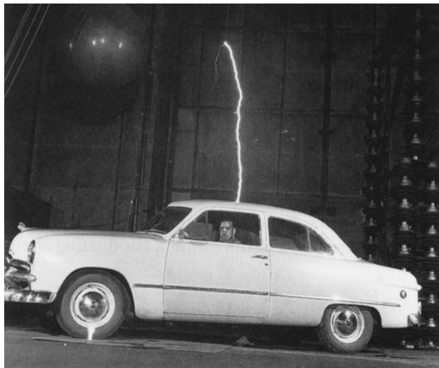
Obr. 25.20 Do karosérie auta udeřila mohutná elektrická jiskra a pak přeskočila přes izolující levou přední pneumatiku do země (všimněme si záblesku v tomto místě), aniž zranila osobu uvnitř auta.
