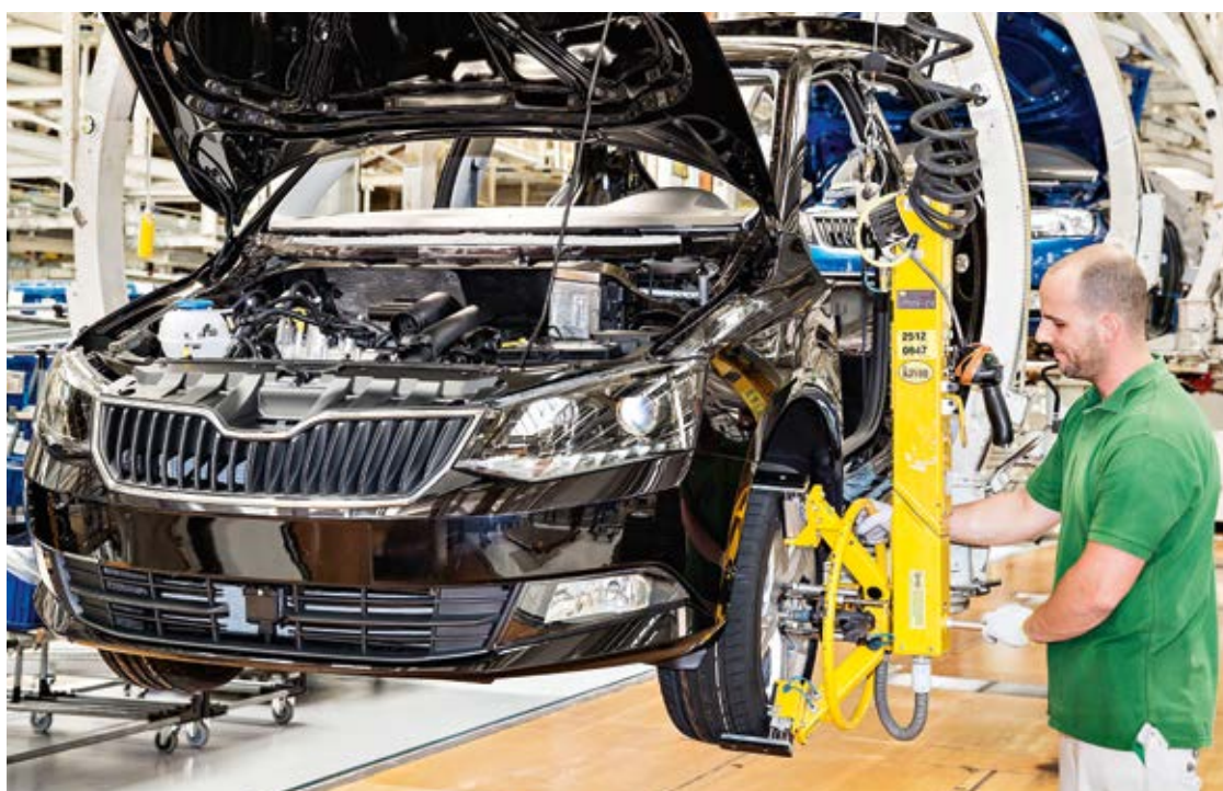
Příklad ergonomicky optimalizovaného pracoviště na montážní lince vozů ŠKODA: při montáži kol pomáhá obsluze linky manipulátor.
